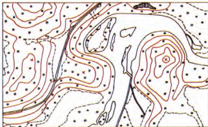
شکل ۱-۷ ج- نقشه توپوگرافی تهیه شده از تصویر قائم شکل ۱-۷ ب
