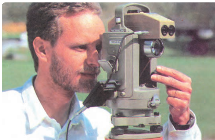
شکل ۲۳-۴ نصب فاصله‌یاب روی دوربین
