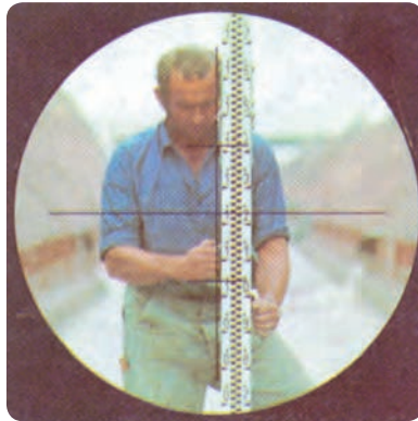
شکل ۱۴-۸- طریقه‌ی نگاه داشتن میر
